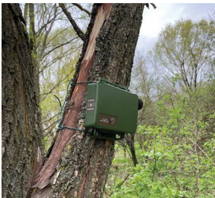
Obr. 5. Ultrazvukový detektor a Songmeter použitý na monitoring netopierov
