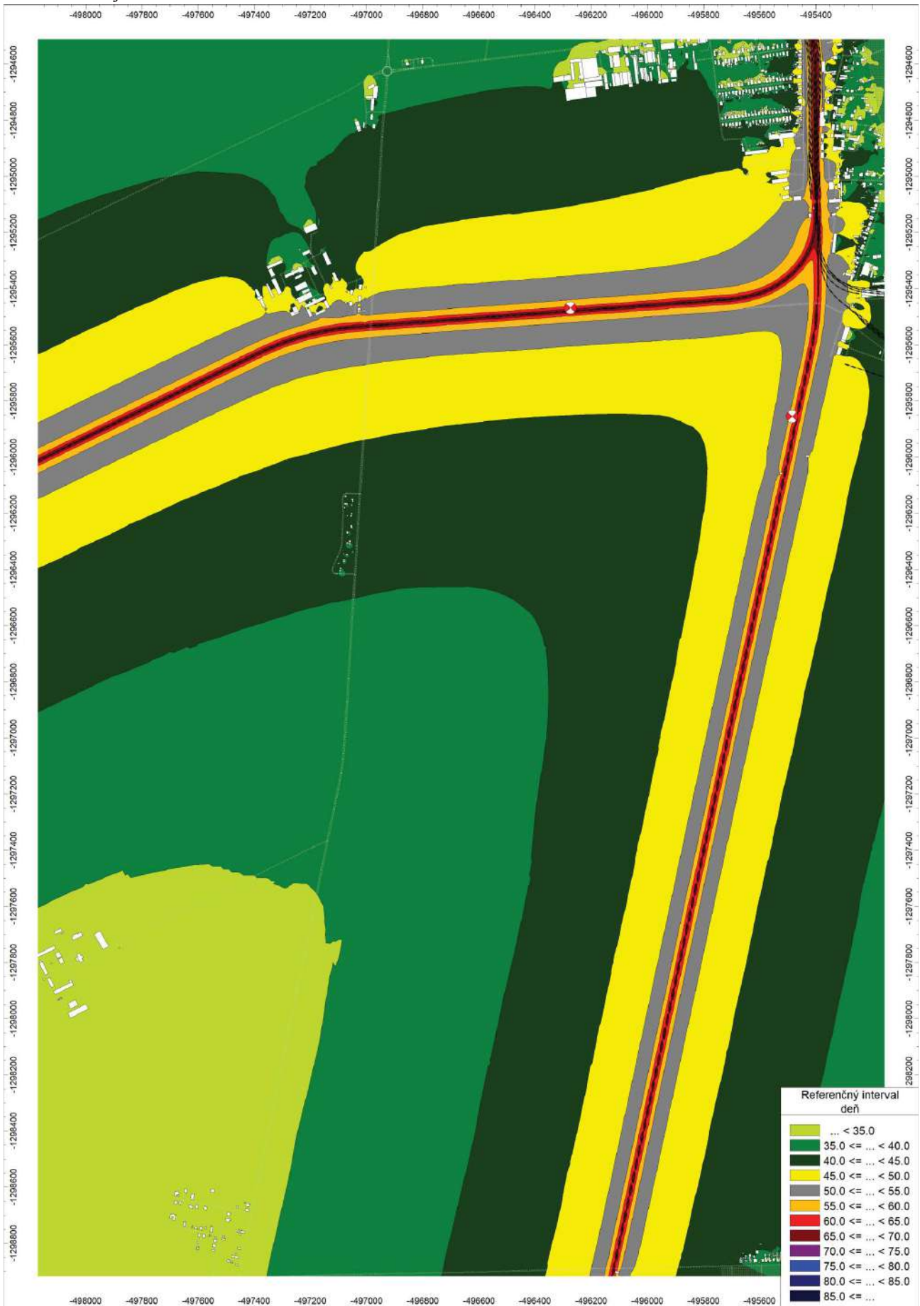
Príloha 7.13: Hluková mapa – Vplyv hluku zo železničnej dopravy na dotknuté vonkajšie prostredie – L_{R,Aeq,d} [dB] vo výške 1,5m nad terénom v súčasnom stave – ref. interval deň
