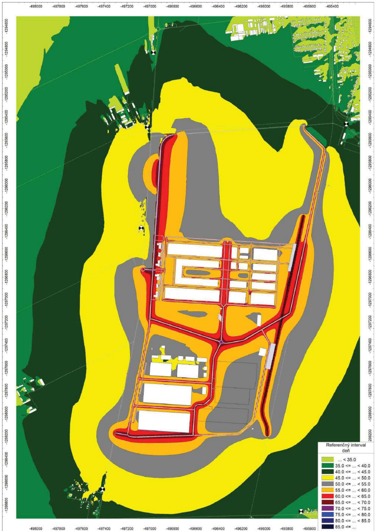
Príloha 7.25: Hluková mapa – Vplyv hluku z iných zdrojov na dotknuté vonkajšie prostredie – L_{R,Aeq,d} [dB] vo výške 1,5m nad terénom v budúcom stave so započítaním dopravnej zátáže 1.etapy aj 2. etapy + PHO – ref. interval deň
