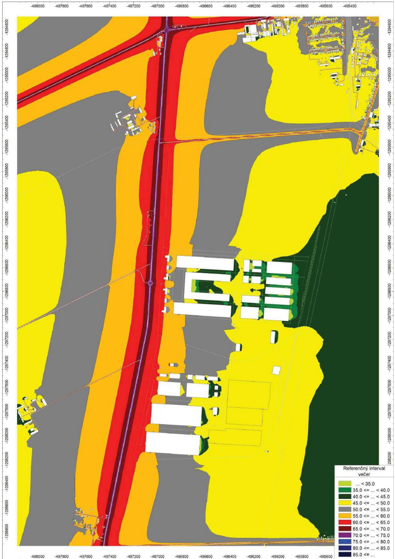
Príloha 7.5: Hluková mapa – Vplyv hluku z pozemnej dopravy na dotknuté vonkajšie prostredie – L_{R,Aeq} v [dB] vo výške 1,5m nad terénom v budúcom stave (Scenár pre rok 2026) – ref. interval večer
