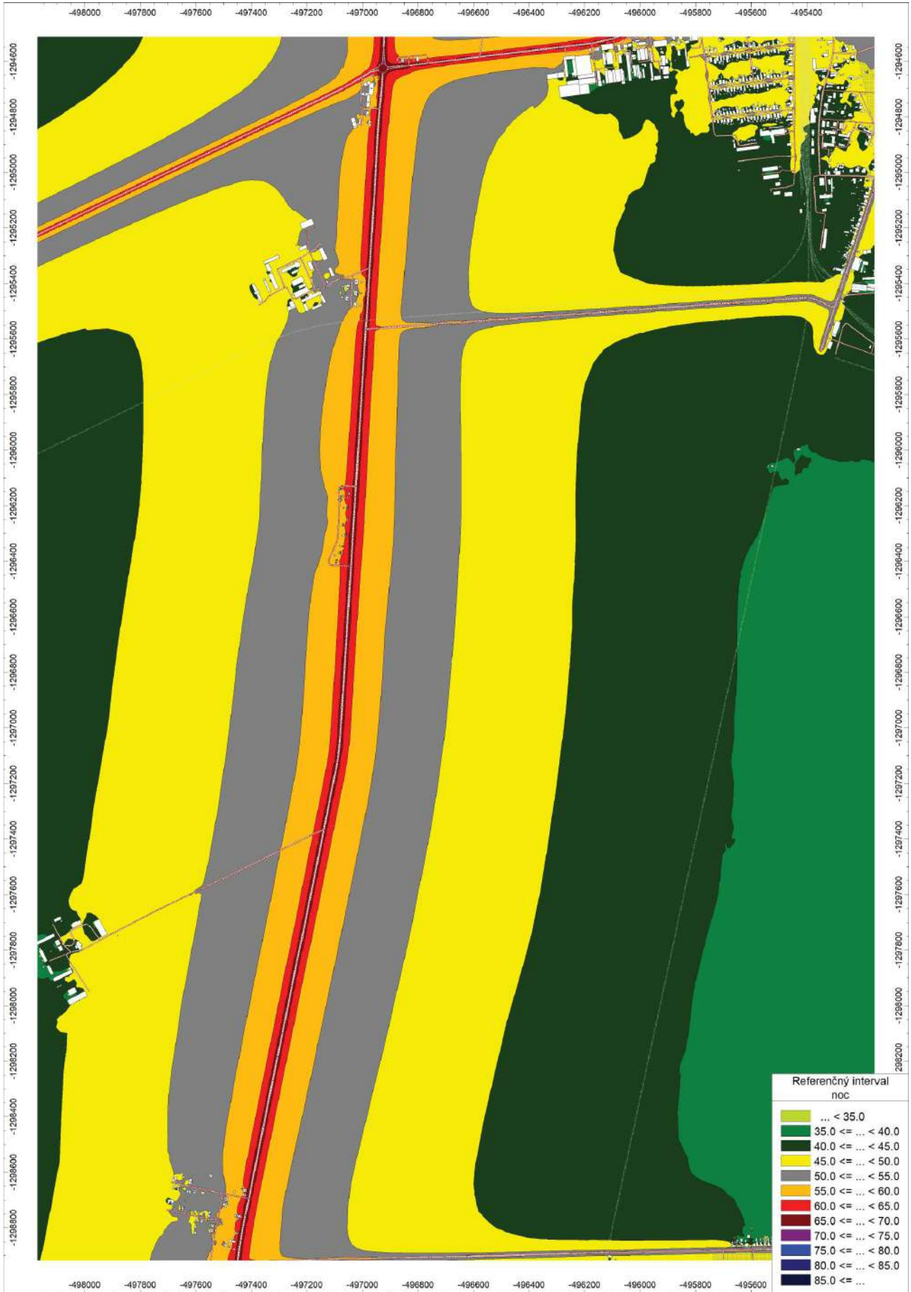
Príloha 7.3: Hluková mapa – Vplyv hluku z pozemnej dopravy na dotknuté vonkajšie prostredie – L_{R,Aeq,n} [dB] vo výške 1,5m nad terénom v súčasnom stave – ref. interval noc
