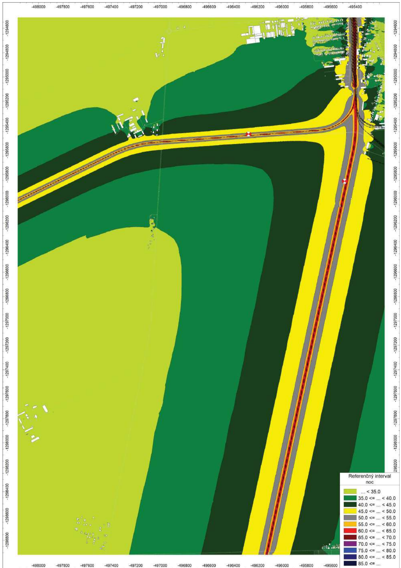
Príloha 7.15: Hluková mapa – Vplyv hluku zo železničnej dopravy na dotknuté vonkajšie prostredie – L_{R,Aeq,T} [dB] vo výške 1,5m nad terénom v súčasnom stave – ref. interval noc
