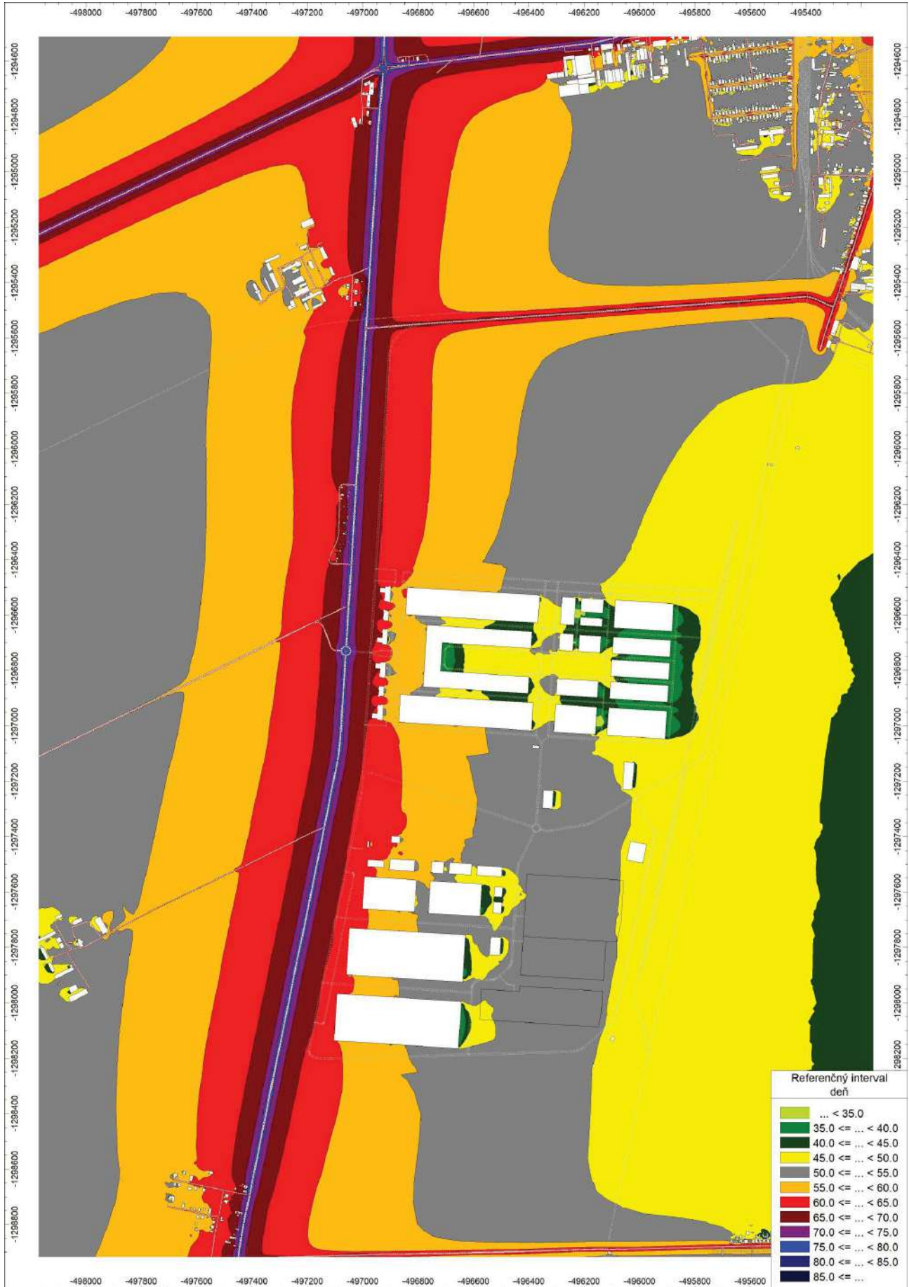
Príloha 7.7: Hluková mapa – Vplyv hluku z pozemnej dopravy na dotknuté vonkajšie prostredie – L_{R,Aeq,d} [dB] vo výške 1,5m nad terénom v budúcim stave (Scenár pre rok 2046) – ref. interval deň
