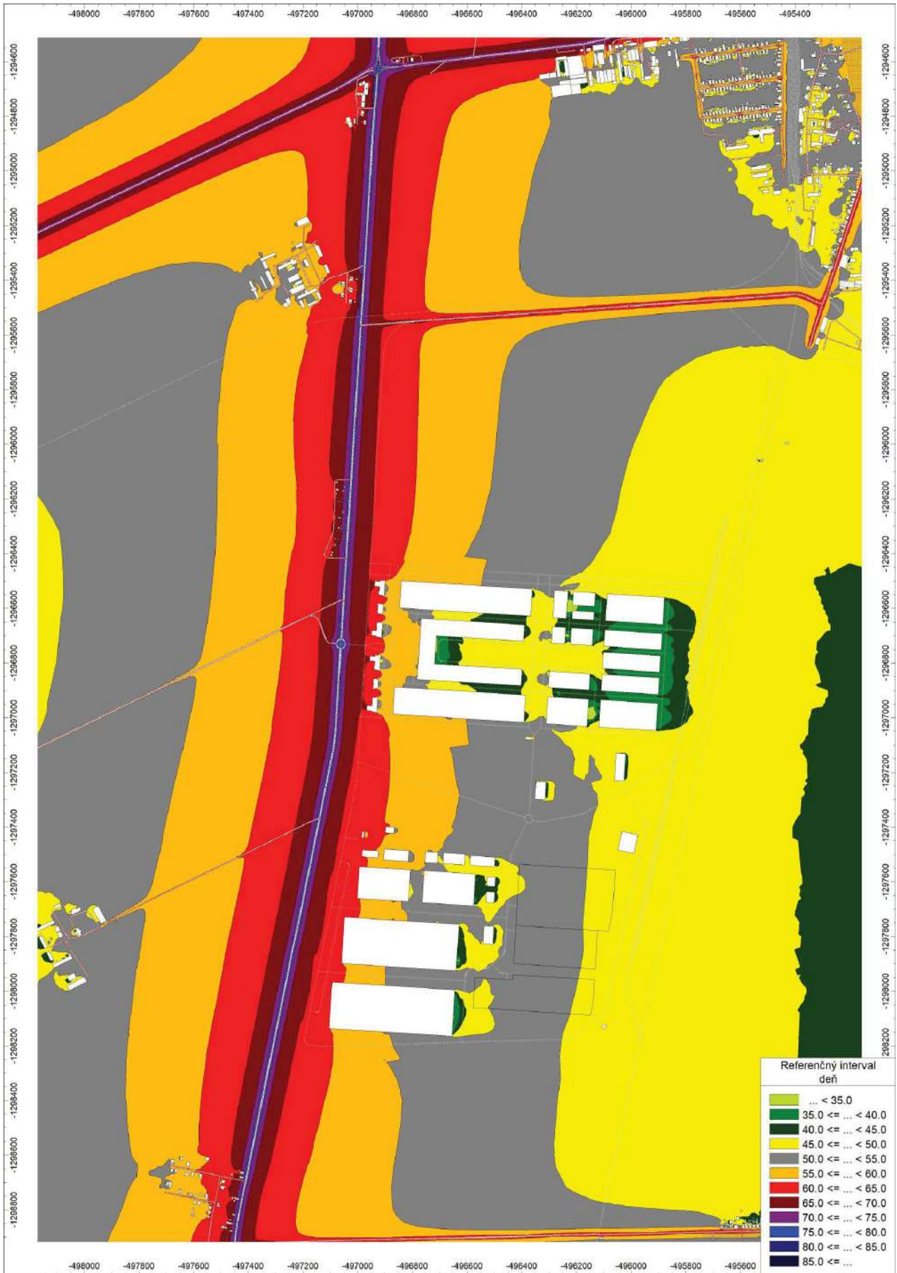
Príloha 7.4: Hluková mapa – Vplyv hluku z pozemnej dopravy na dotknuté vonkajšie prostredie – L_{R,Aeq,d} [dB] vo výške 1,5m nad terénom v budúcom stave (Scenár pre rok 2026) – ref. interval deň
